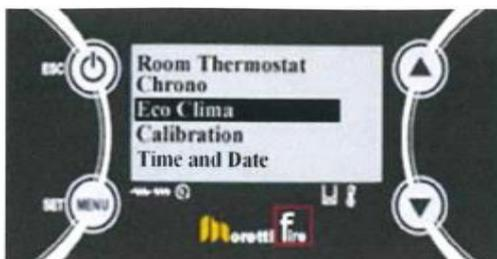
2:P2ボタンを押してメニューに入り、エコ運転を有効(Enable)にするか無効(Disable)にするかを選択し、P2のボタンを押して設定を確定させます。
