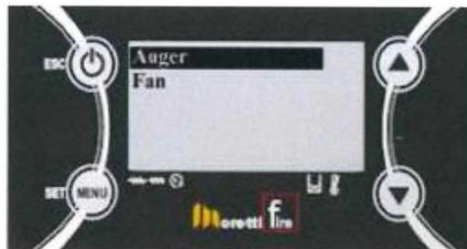
3:P2 を押して選択したメニューに入り、P3 または P4 ボタンで数値を変更し、P2 ボタンを押して変更を確定します。画面には以下のように表示されます。最大+7 から最少-7 まで設定することができます。
