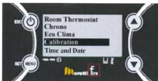
2:P2を押してメニューを進み、P3またはP4ボタンを押して「Auger」・「Fan」を選択します。
