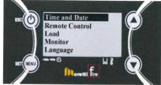
2:P2 ボタンを押してメニューを進み、P3 または P4 ボタンを押して変更する数値を選択し、P2 ボタンを押します。その後、P3 または P4 ボタンで数値を変更し、P2 ボタンを押して確定します。
