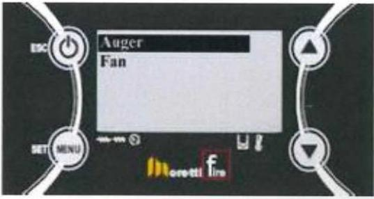
3 : P2 を押しして選択したメニューに入り、P3 か P4 ボタンで数値を変え、P2 ボタンを押しして変更を確定します。画面には以下のように表示されます。最大+7 から最少-7 までで設定することができます。
