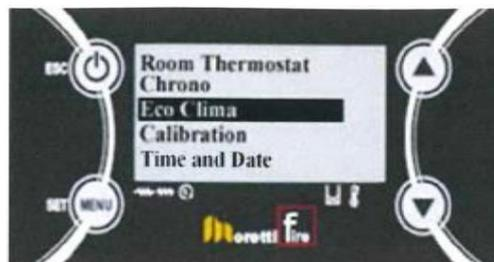
2：P2ボタンを押ししてメニューに入り、エコ運転を有効(Enable)にするか無効(Disable)にするかを選択し、設定を確定するためにP2のボタンを押しします。
