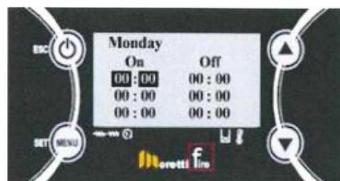
6：曜日ごとに3パターンのタイマーを設定できます。1つめの点火タイマーをセットするためにP2ボタンを押し、P3かP4ボタンを押し時間を変え、それからP2ボタンを押し変更を確定させます。
