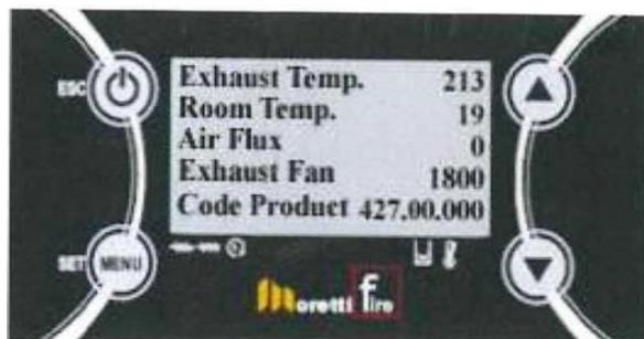
Exhaust Temp.(排気ガスの温度)
