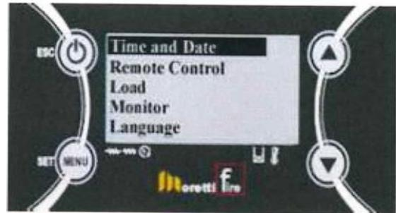
2 : P2 ボタンを押ししてメニューを進み、P3 か P4 ボタンを押しして変更したい数値を選択し、P2 ボタンを押します。それから P3 か P4 ボタンで数値を変更して、P2 ボタンを押しして確定します。
